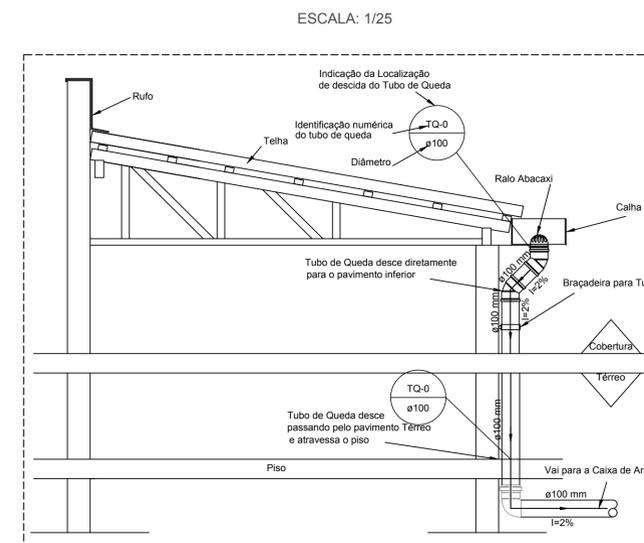
DETALHE - TUBO DE QUEDA DAS ÁGUAS PLUVIAIS
